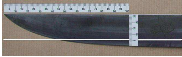
Het mes P1, waarop aangegeven de breedte van het lemmet bij 10 cm diepte is 2.6 cm
